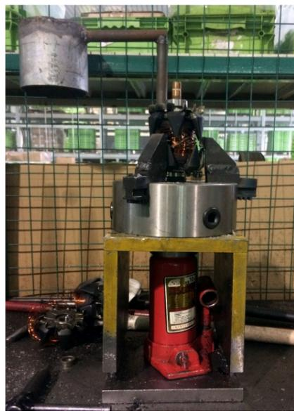
拆卸工装简便快捷,而且现在我们车间人人都能操作,现在谁有空就可以进行拆卸,很好的解决了报废转子积压的问题。
